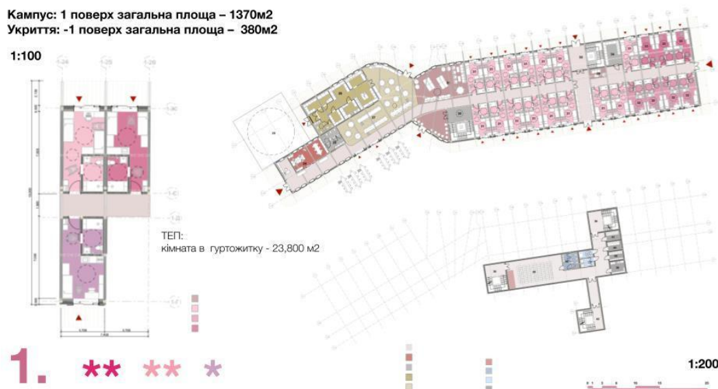
Рисунок 4.2 – Кампус: планування 1 поверху (житло) і -1 поверху(укриття)
